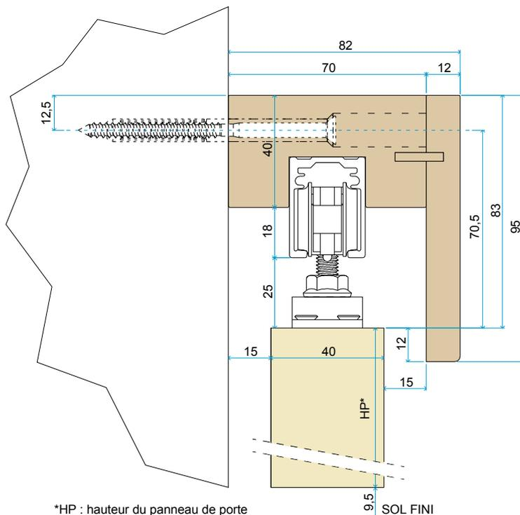
Paris est un kit complet pour la pose en applique d'une porte coulissante en bois. Le cache-rail et le montant de butée sont en bois revêtu de PVC blanc et ne nécessitent aucune peinture. Le montant de butée est vendu séparément.
