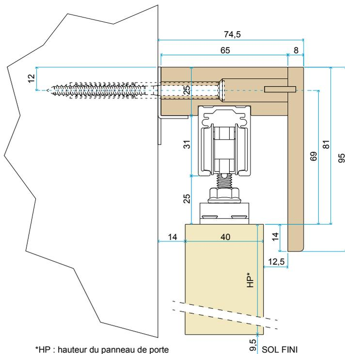
A2 est un kit complet pour la pose en applique d'une porte coulissante en bois. Le cache-rail et le montant de butée sont composés de bois brut à peindre. Ce kit existe en deux versions : A2-A (sans montant de butée) et A2-B (avec montant de butée).
