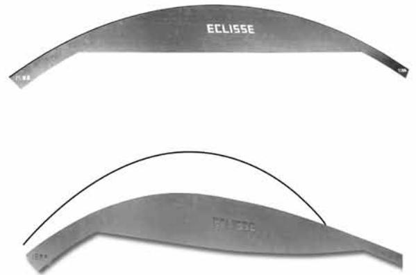
3c) Positionner le gabarit cote "0" et tracer l'arrondi au sol.
