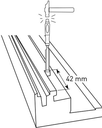
**A.** Réaliser une encoche 10x10x42 mm en bas de chaque montant avec un ciseau à bois et un marteau.
