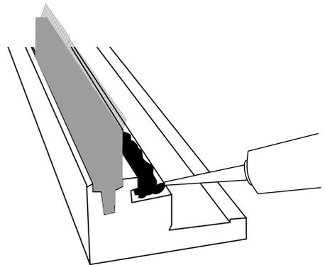
**D.** Déposer de la colle (type silicone, non fournie) dans la rainure adjacente.
